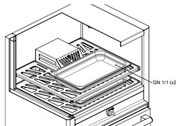
Températures secondaires du support de plateaux dans le meuble supérieur d'environ 150°C, basé sur un four à 300°C.
